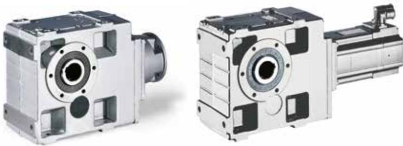
我们的螺旋伞齿轮减速机拥有高扭转刚度和低回转间隙，有助于实现定位的极致精度和可重现性。其优化了的齿形设计和磨削齿轮确保了其低噪音性和低回转间隙。
