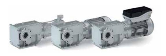
伞齿轮减速机机身轻巧,以其高容许径向力、高分布密度减速比和低回转间隙脱颖而出。该减速机目前支持2级和3级两种设计,最大转矩可达450Nm,减速比i可达360,具体需根据实际应用而定。
